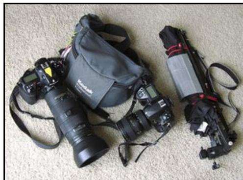
Le pied est un *Bogen 3373*, compact en 5 sections, modifié (percé) pour y fixer une sangle. Il est surmonté d'un adaptateur parapluie/pied standard avec un sabot pour flash. Un parapluie
