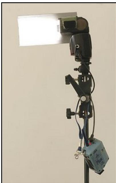
Pour fabriquer un *gobo* de bonne taille, découpez un morceau de carton afin d'obtenir un rectangle d'environ 10x20 centimètres. Recouvrez-le avec du ruban adhésif et collez du *Velcro* d'un côté (le côté des crochets), à environ un tiers de la longueur. Vous pourrez ainsi l'attacher au bord de votre flash de n'importe quel côté et décider de combien vous voulez qu'il dépasse du flash.
